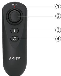
① **指示灯:** 通过灯颜色可判断当前赤道仪所处模式, 亮灯时表示控制摇杆在高速模式下
