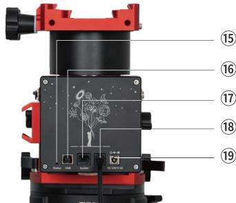
⑯ **模式指示灯:** 显示红灯, 为赤道仪模式, 显示绿灯, 为经纬仪模式 (赤道仪在没有同步时间、地点的情况下指示灯为红绿交替闪烁, 同步时间后会根据所处模式显示相应颜色指示灯)
