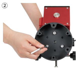
再用 3 颗内六角螺丝将第二节增高节固定在第一节上，接上安装盘固定好
