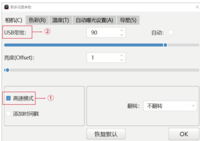
3.4 曝光时间对帧率的影响。帧率就是每秒输出多少幅图像,常用fps表示。分辨率不变的情况下, 帧率=1s/曝光时间 (s) , 即曝光时间为1秒时候, 帧率为1 fps。
