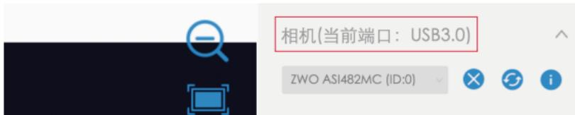
如果当前端口显示 USB2.0，请检测是否使用的是 USB 3.0 数据线，同时检查并确认电脑端接口为 USB 3.0。
