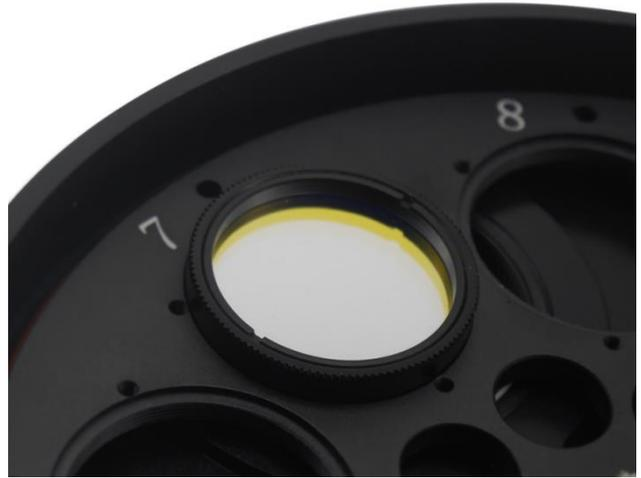
对于 31 毫米、36 毫米以及 51 毫米的无框滤镜（请使用包装盒中的 M2 螺丝和档光圈来固定滤镜）：
