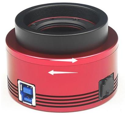
3. 对于 ASI183/1600/294/533 这些冷冻相机，松开前面板上的四颗螺丝即可打开前面板。
