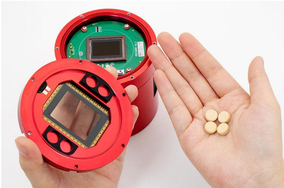
2. 将干燥剂放至微波炉中，中火加热 2 分钟。
