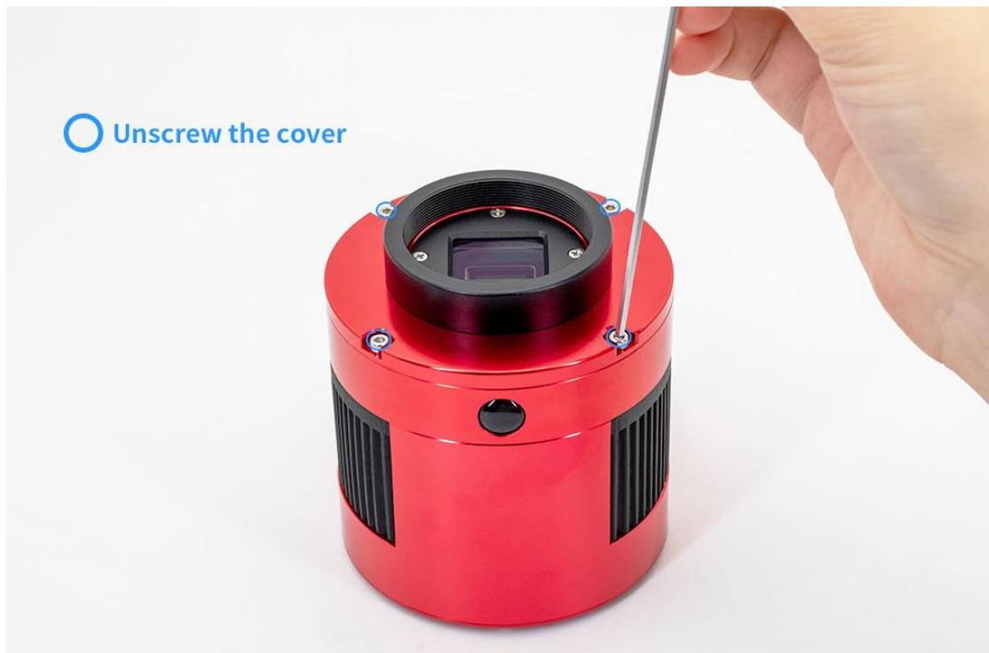
4. 对于 ASI071/2600/6200/2400 等芯片尺寸较大的相机，稍微复杂一点，需要按照下面步骤打开相机前面板。
