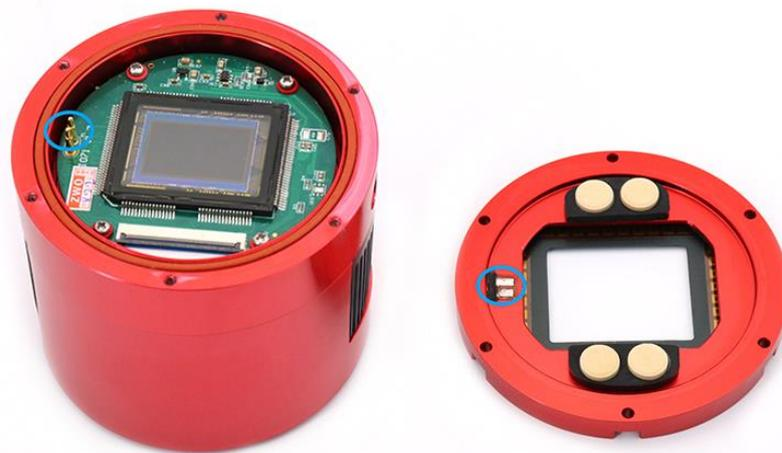
◆ 使用之前取下来的 3 颗大号螺丝，重新固定好倾角调节环。请注意边角的 6 个小螺丝需要在安装完 3 个大号螺丝后再固定。
