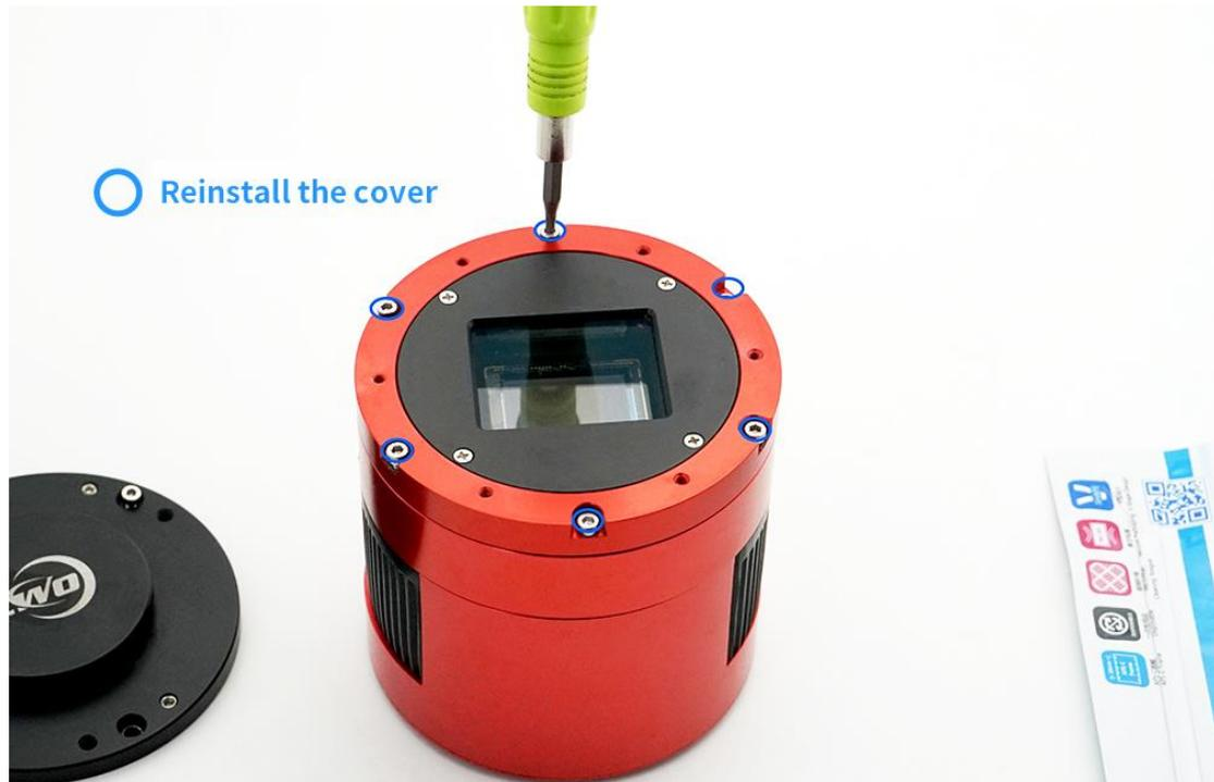
◆ 请将圆圈中部分对准后再实行密封。
